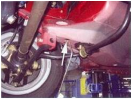
42. Полость соединителя переднего лонжерона и пола.
