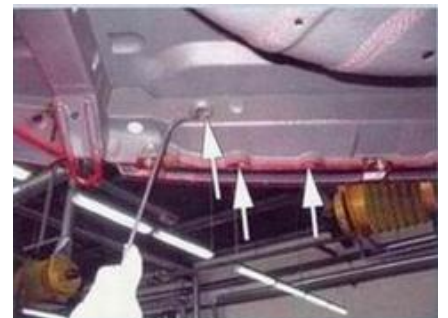
50.3. Полость заднего лонжерона.
