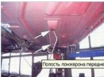
45. Полость лонжерона переднего пола.
