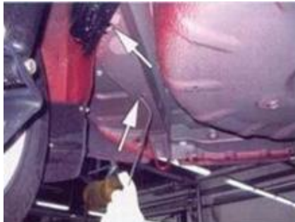
50.1. Полость заднего лонжерона.
