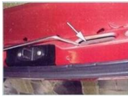
34. Полость задней верхней поперечины.
