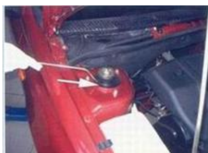
27. Опора пружины передней подвески.
