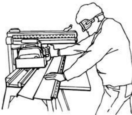
Электропила. Стационарная или ручная циркулярная электропила ускорит резку сайдинга. Подойдет полотно с тонкими зубьями, его нужно установить на движение в обратном направлении. В особенно холодную погоду двигайте пилу по материалу медленно, чтобы предотвратить отламывание кусочков или растрескивание материала.
