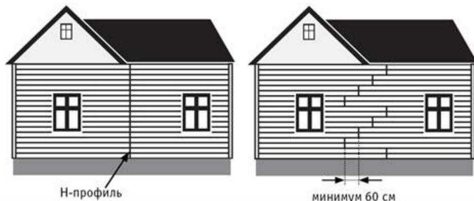
Н-профиль закрывает соединение панелей, делая его более надежным и красивым. Внешне получается одна сплошная полоса сверху донизу, которая смотрится единым целым с внешними и внутренними углами, J-профилями, остальной фурнитурой, не выбиваясь из общего стиля здания. Зазор между сайдингом и профилем - 6 мм.
