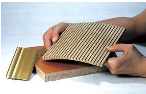
Для изогнутых перегородок мы используем специальный <деревянный> материал Топан (Toran Form), разработанный немецкой фирмой Glunz AG. Этот материал сделан из МДФ. С одной стороны его поверхность - гладкая и ровная, а с другой - <разрезанная>. Эта особенность и позволяет придать полке или стене изогнутую форму.
